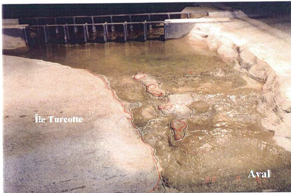
Bras gauche en conditions actuelles vu de l'aval, niveau de lac 21.24m
